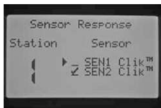
Только 2й датчик запрограммирован на 1ю зону
