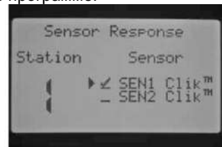
Только 1й датчик запрограммирован на 1ю зону
