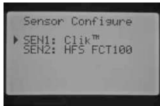
SEN 1 – метеодатчик SEN2 – датчик потока (HFS FCT100)
