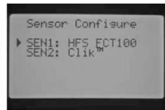
SEN 1 – датчик потока (HFS FCT100) SEN2 – метеодатчик
